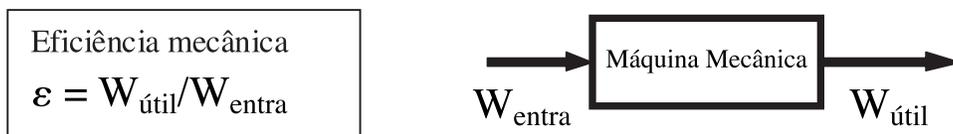
*Eficiência térmica:* Nas máquinas térmicas, responsáveis pela transformação de calor em trabalho, uma grande quantidade da energia adicionada para sua operação é rejeitada para o meio ambiente. Então a eficiência da máquina é a relação entre a energia que realmente é utilizada e a energia fornecida. Desta forma, o uso eficiente da energia agride menos o meio ambiente porque a energia fornecida ou rejeitada vai ser menor.
