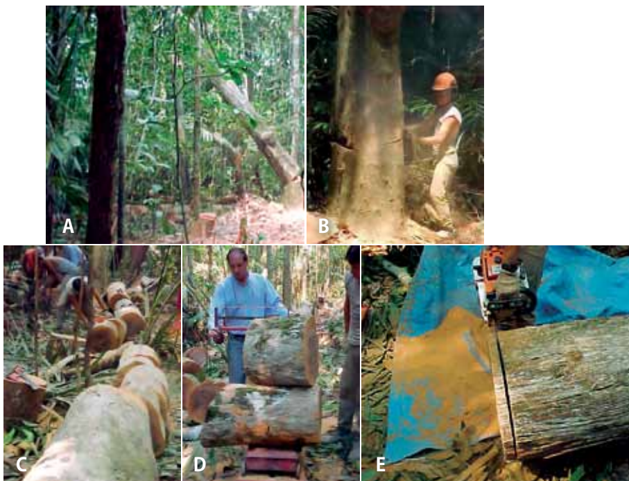
Figura 4: Procedimentos de campo para determinação da Biomassa Florestal. (a) Inventário Florestal; (b) Derrubada da árvore; (c) Separação do tronco; (d) Pesagem do tronco; (e) Retirada de amostras para determinação dos teores de água e carbono.
