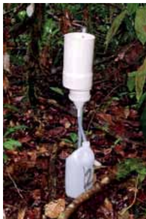
Figura 5: Dois tipos de medidores de chuva: (a) pluviômetros (um cilindro captador e um reservatório) e (b) pluviógrafo (um cilindro captador e um registro automático de dados).
