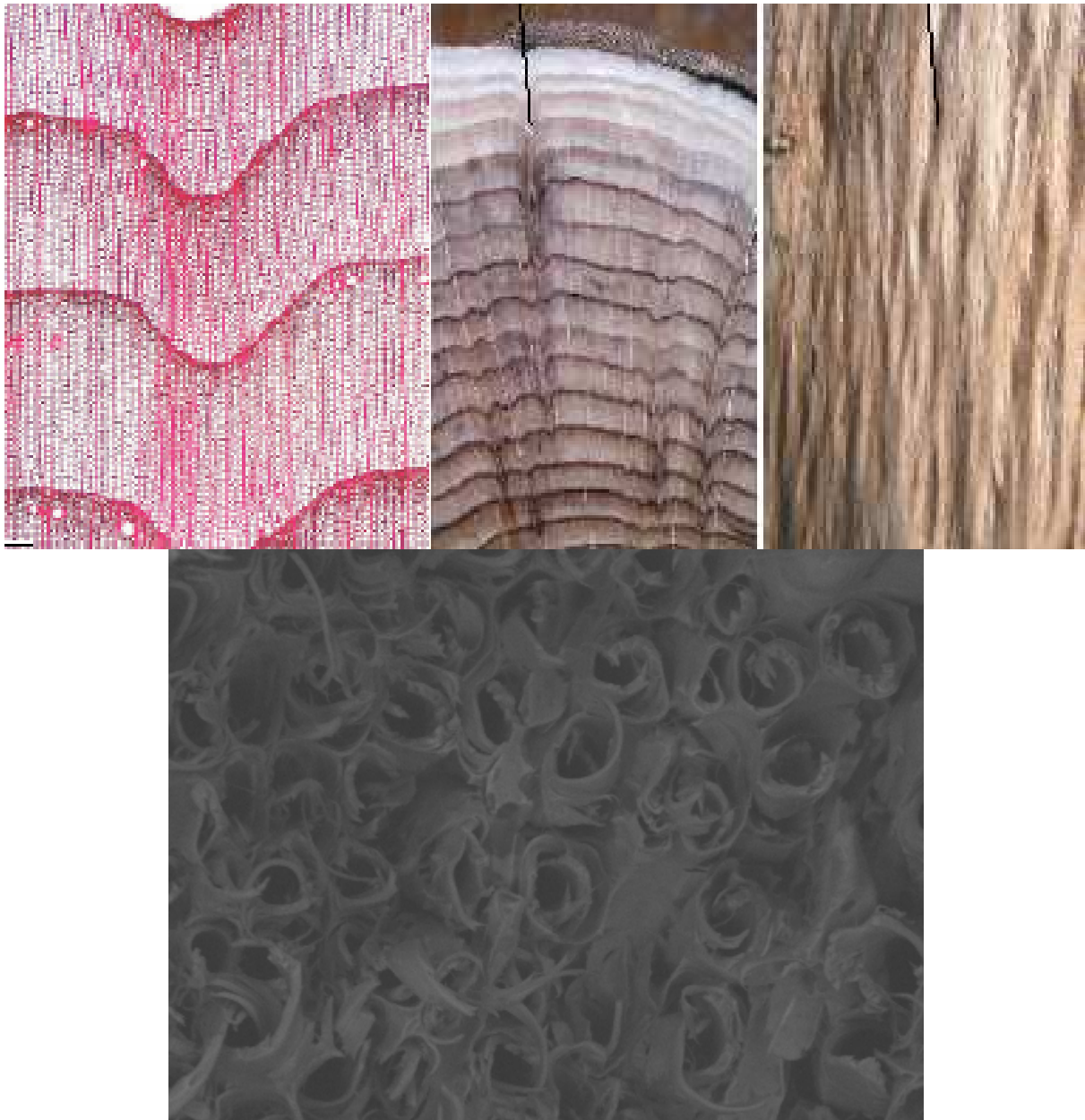
Figura 126: Lenho de compressão em coníferas (Fonte: Schweingruber et al. 2008). Imagens em microscopia eletrônica dos traqueoides no lenho de compressão de pinus (Fonte: LANAQM, 2016).
