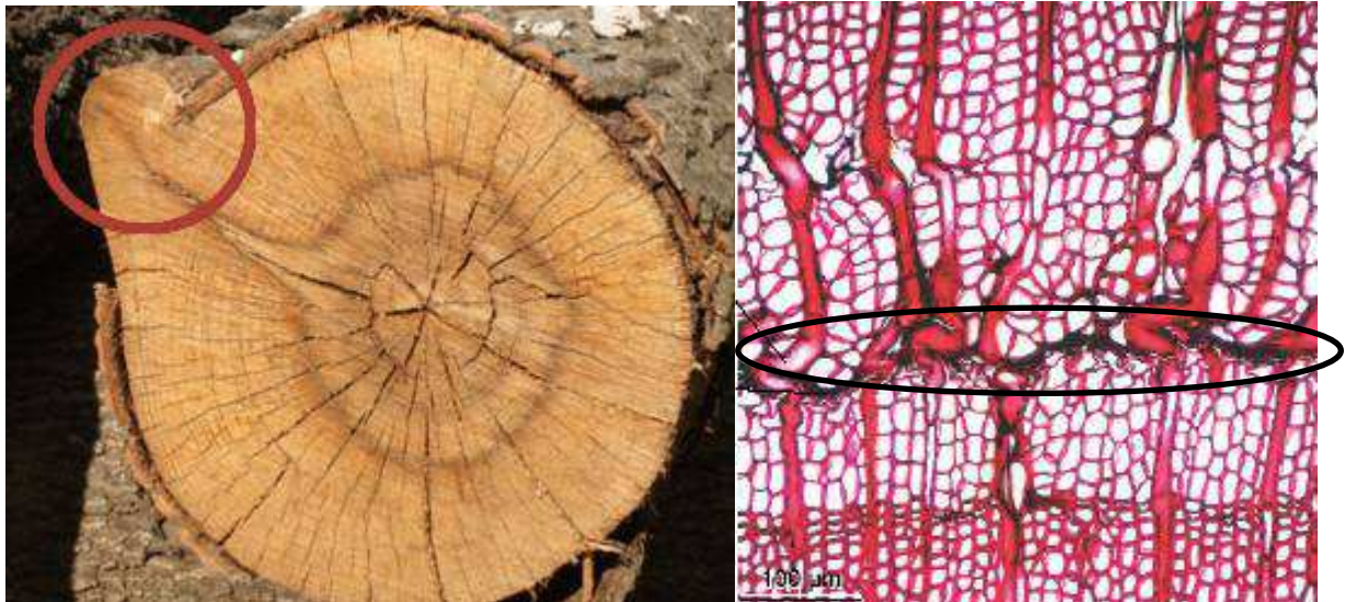
Figura 131: Fendas de frio (Fonte: http://www.pannonpower.hu/en/biomass/wood-defects ) traqueoides colapsados devido ao frio (Fonte: Schweingruber et al. 2008)
