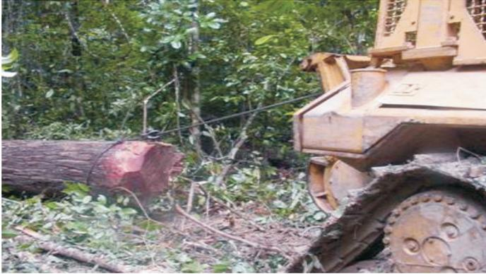
**Fig. 37.** Arraste de tora com extremo levantado.
